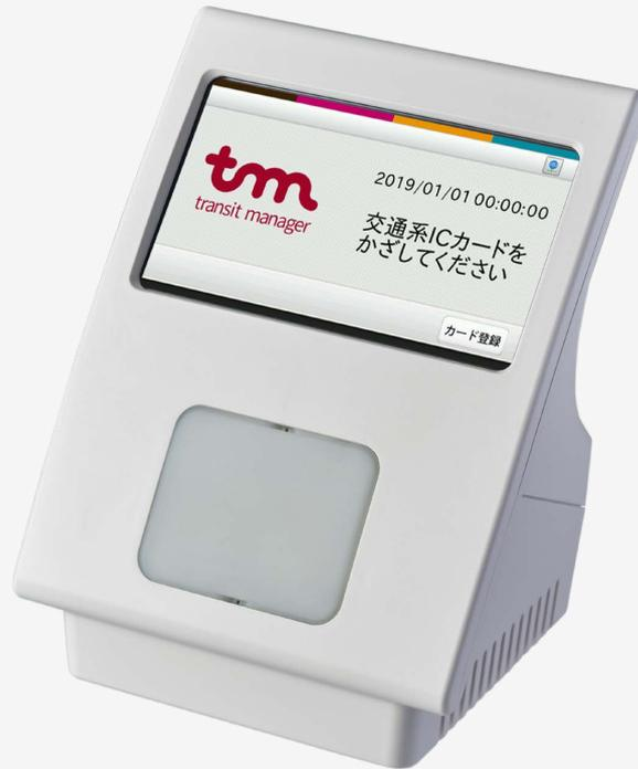
ピットタッチ・プロ3はFeliCaカードに対応しておりますので、交通系ICカードをセンサー部にかざすことで、乗車履歴情報を読み取り、サーバーに送信することができます。
