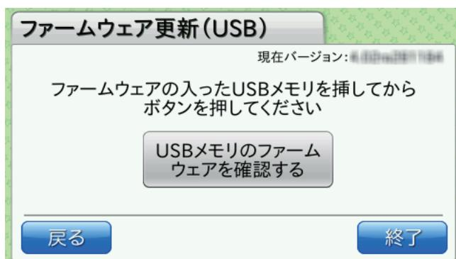
ファームウェアを USB メモリから更新する場合は、USB ポートにファームウェアが入っている USB メモリを挿入し、[USBメモリのファームウェアを確認する] ボタンを押します。USB メモリ内のファームウェアを確認します。
