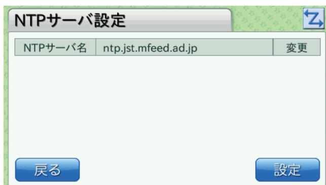
**NTP サーバ名** NTP サーバのホスト名または IP アドレスを入力します。この項目を設定すると、設定後または起動後に NTP サーバに接続し、時刻が設定されます。
