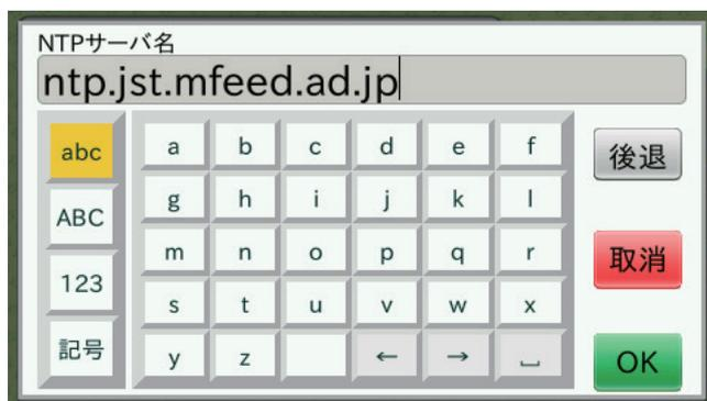
入力後 [OK] ボタンを押すと、NTP サーバ設定画面に戻ります。NTP サーバ設定画面で [設定] ボタンを押すと、設定が反映されます。
